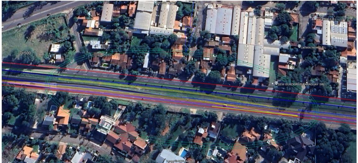
Una opción puede contemplar prolongar el ramal soterrado y que emerja a nivel superficie una vez que la faja ferroviaria vuelva a tener los 10 metros requeridos. En sector restringido a 5-6 metros se puede considerar poner una losa sobre el ramal soterrado para totalizar los 10 metros requeridos.
