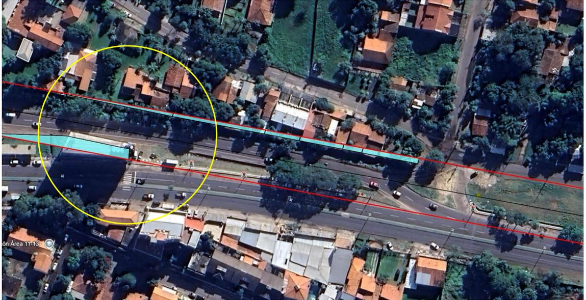
El problema se ve agravado debido a que el eje de la Ruta Ñu Guasu se desplazó en dirección al norte con respecto al eje de la faja vía en el sector del enlace.
