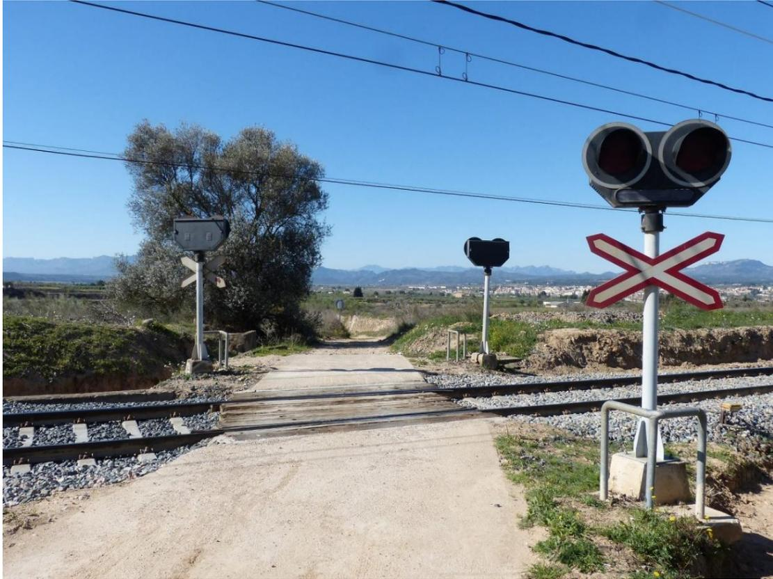
Figura 7.1: Elementos ferroviarios para la información en el tránsito vial.
